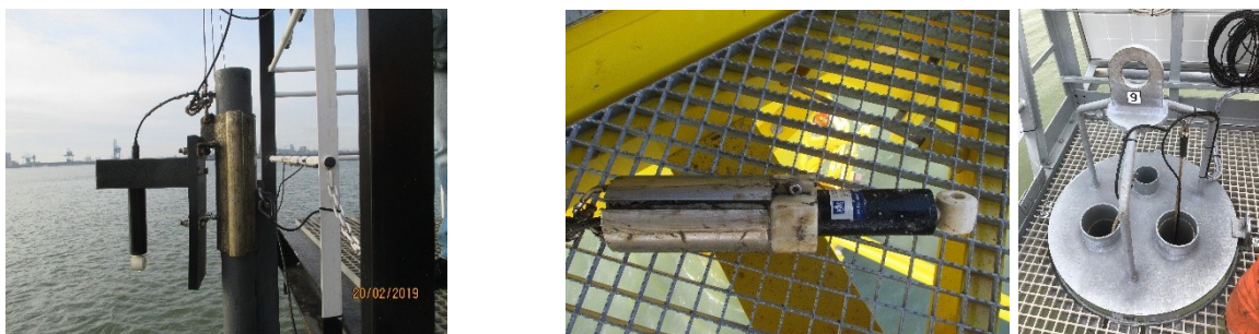
Figuur 5 t/m 7 - Impressie van manieren van bevestiging, v.l.n.r. blok, dompel en buis voor dompel
